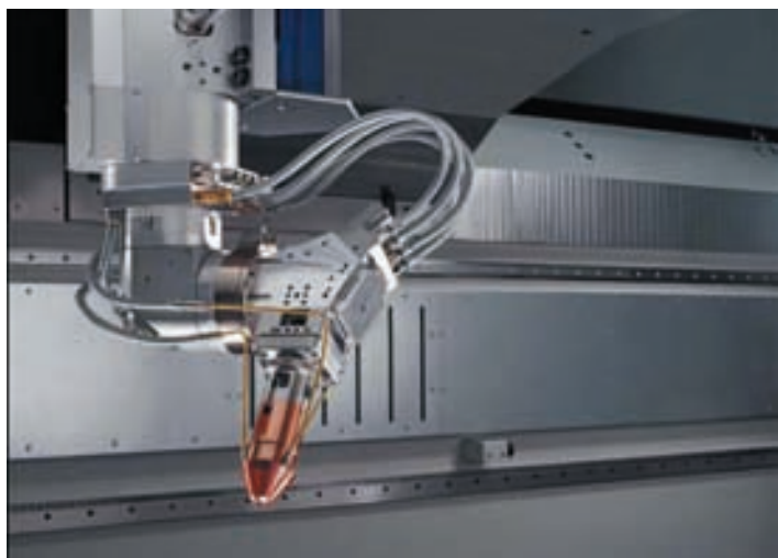
Obr. 4 Hlava pro práškové navařování ve stroji TruLaser Cell
